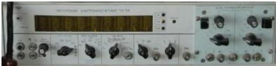
Частотомер ЧЗ-34А электронно-счетный предназначен для автоматического измерения частоты электрических колебаний, периода электрических колебаний, интервала времени, отношения частот, выдачи кодированных сигналов результатов измерений.
