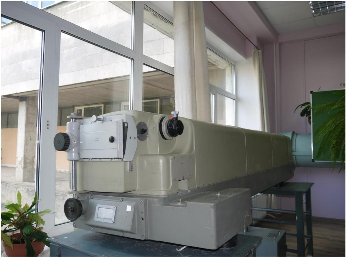
Дифракционный спектрограф ДФС-8-2. Фокусное расстояние зеркального объектива прибора - 2,65 м. Регистрируемая область спектра  $2\ 000 - 10\ 000\ \text{Å}$ . В спектрографе используется дифракционная решетка (реплика) с числом штрихов 1200 штр/мм. Обратная линейная дисперсия прибора - 0,3 нм/мм. Регистрация спектров - фотографическая. Назначение спектрографа - качественный и количественный спектральный анализ сталей и сплавов.
