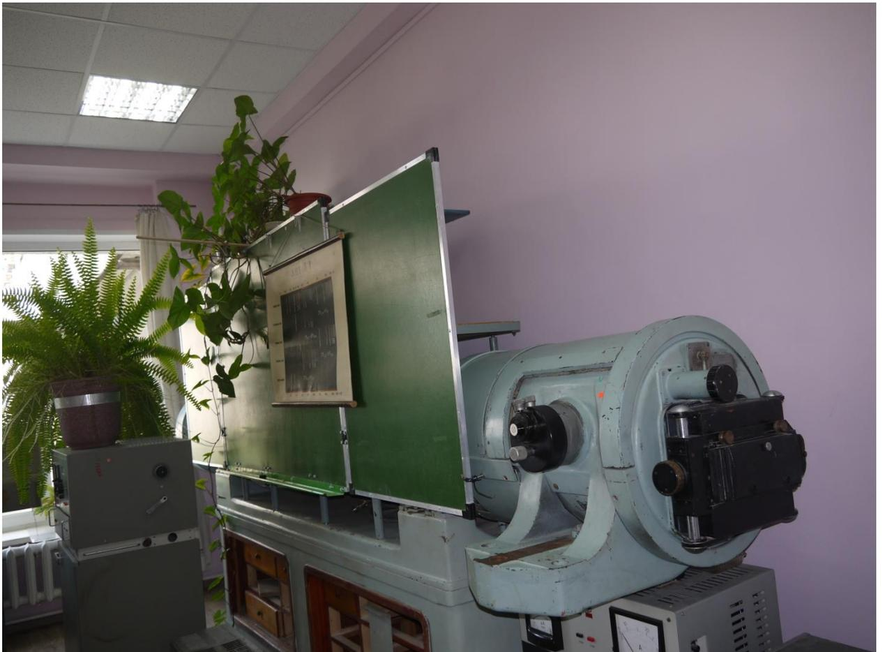
Дифракционный спектрограф ДФС-3. Фокусное расстояние зеркального объектива прибора- 2,65 м. Регистрируемая область спектра 2 000 - 10 000 Å°. В спектрографе ДФС-3 используется оригинальная дифракционная решетка ( 1200 штр/мм). Обратная линейная дисперсия прибора - 0,3 нм/мм. Регистрация спектров - фотографическая. Назначение спектрографа - качественный и количественный спектральный анализ сталей и сплавов
